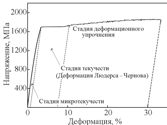
Рис. 1. Кривая статического растяжения стали ВНС-9Ш [25].
