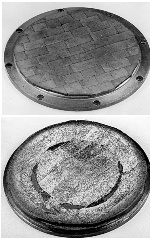
Рис. 1. Составная магнетронная мишень из литого WSi 2 . — новая и отработанная. Диаметр мишеней 152 мм.
