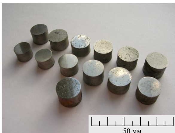
Рис. 3. Образцы спеченных ВПМ на основе шихт Ni – NaCl и Ni – Fe – NaCl.
