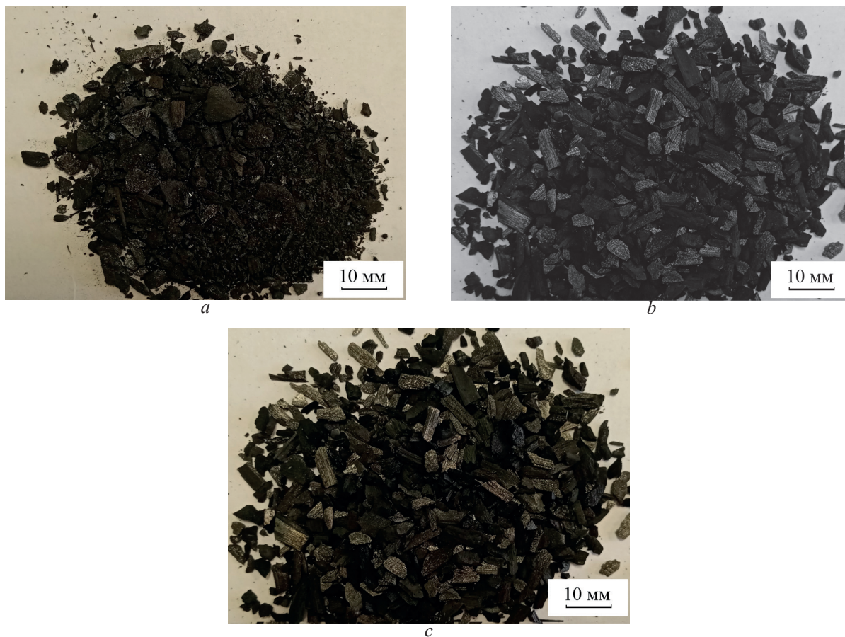
Рис. 1. Порошкообразные угли, использованных для изготовления образцов: a — типа 1; b — типа 2; c — типа 3.
