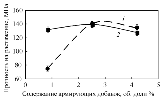
Рис. 4. Зависимость прочности на растяжение от содержания наноразмерных армирующих добавок: 1 – SiC, 2 – ZrO 2 .
