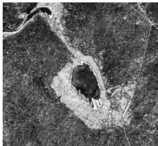
Рис.3. Структура порошковой спеченной композиции железо – чугун, обжатой давлением 9,5 ГПа при температуре 930°С. \times 234 .
